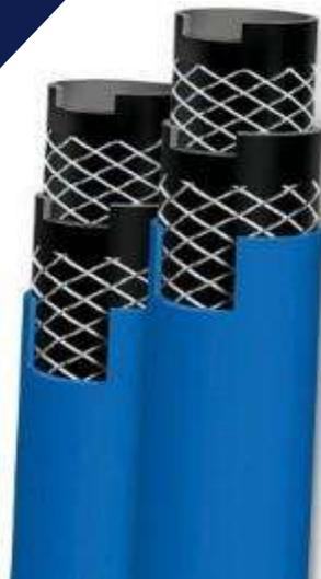
**Recomendação de uso:** A mangueira Lavar Autos é recomendada para a lavagem de automóveis, caminhões, ônibus, tratores e implementos agrícolas com alta pressão. Possuem alta espessura de parede em relação ao diâmetro, o que resulta em excelente flexibilidade. Excepcional adesão entre as camadas. A superfície externa é lisa, facilitando o manuseio e evitando a retenção de resíduos.
